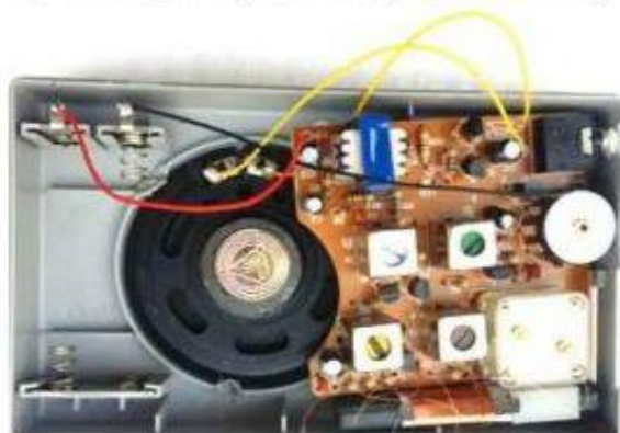
圖七. 8電池彈片固定在機殼上並焊上導線
