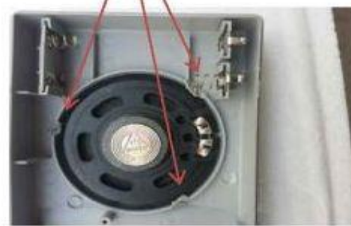
圖五6. LED3mm紅色要焊接在背面 PS:LED要注意極性。 圖六. 7. 如箭頭處3點以烙鐵觸融塑膠 以便固定喇叭。
