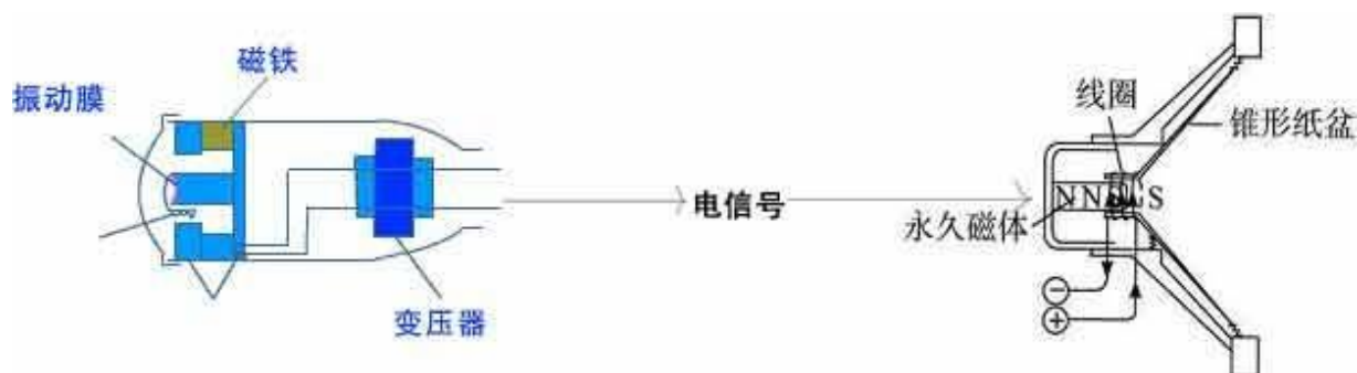
图四 电信号和声音信号相互转换
