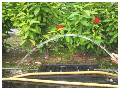
圖 2 角度 45 度左右最遠射程
