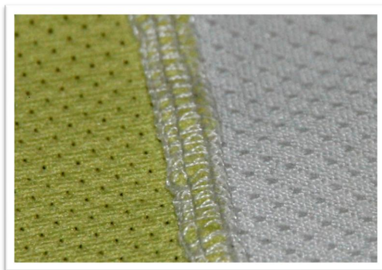
圖 20 拷克縫製的線程，縫合處無鬚狀
