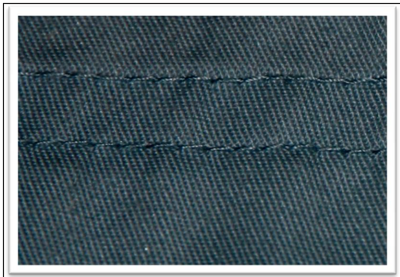
圖 18 雙針平縫機的線程 圖片來源：筆者自行整理
